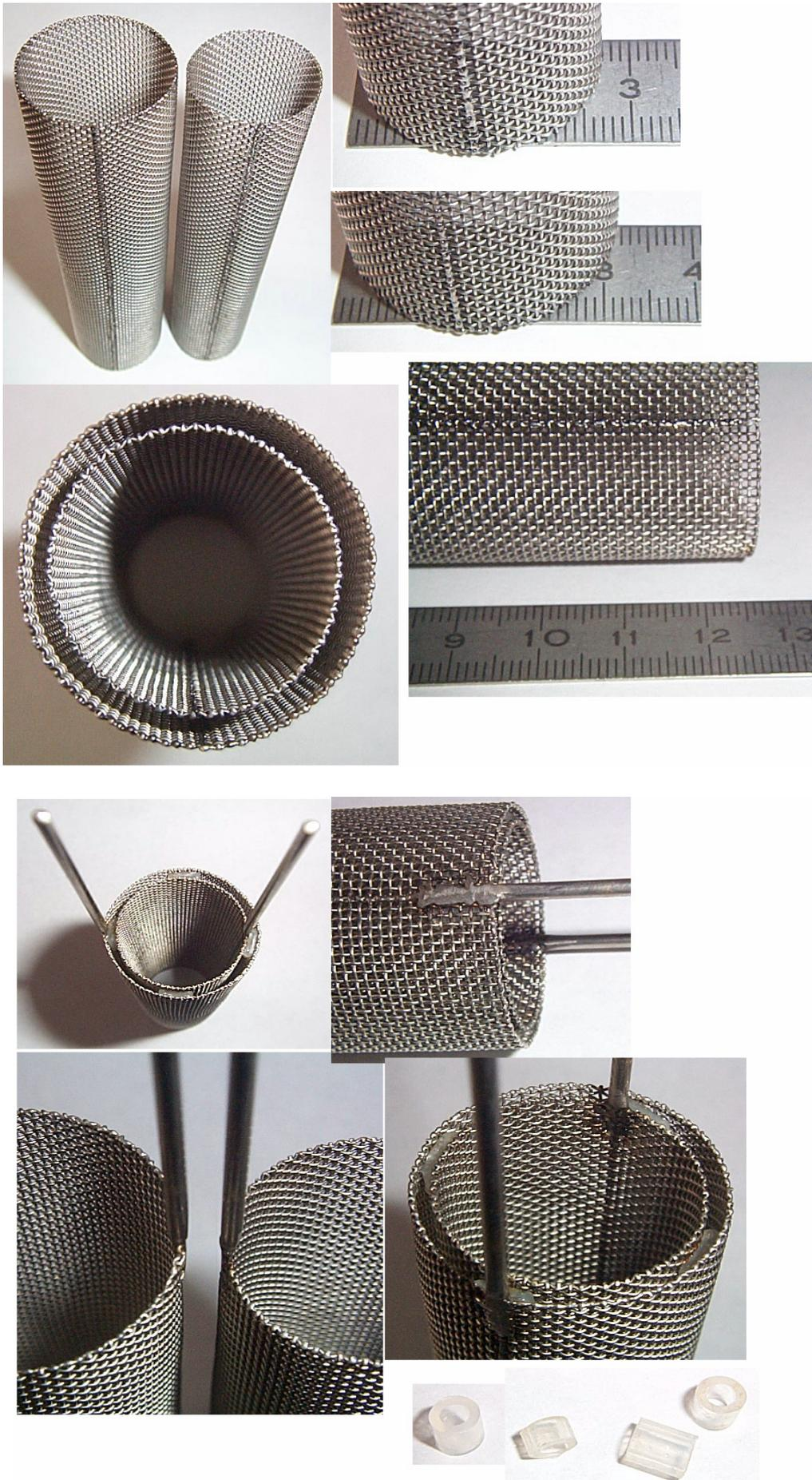
Die Edelstahldrähte für die Stromzufuhr wurden am Ende flach geschmiedet und in die Wand bündig eingeschweißt.
