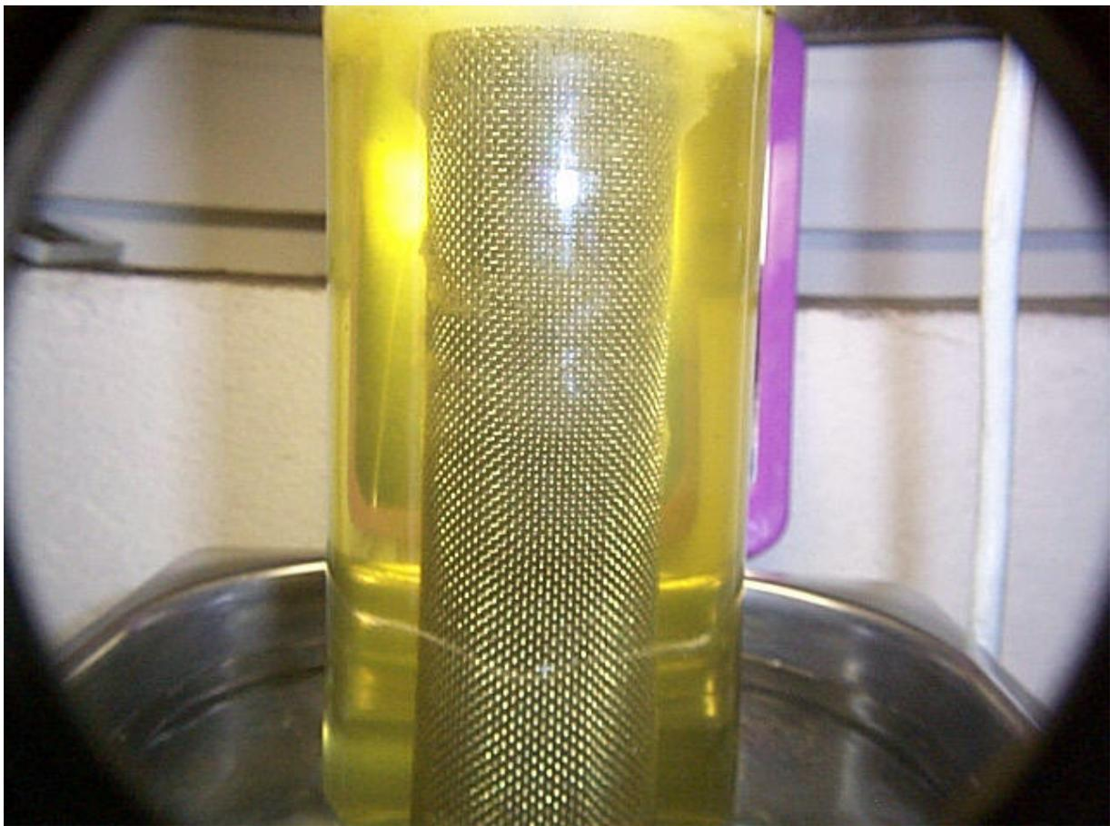
Strom wurde gerade eingeschaltet. Man kann durch die enorme Gasbildung zwischen den Röhren nicht mehr durch die Maschen sehen!
